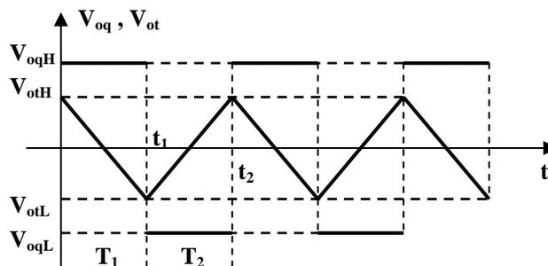
Se al tempo  $t = 0$  la tensione  $V_{oq} = V_{oqH}$ , la tensione  $V_{ot}(t)$  risulta una rampa decrescente (l'integratore è invertente), la cui equazione è:
