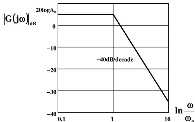
Il primo asintoto è parallelo all'asse delle ascisse; il secondo è una retta con pendenza  $-40 \frac{\text{dB}}{\text{decade}}$  che incontra il primo asintoto per  $\frac{\omega}{\omega_0} = 1$ .
