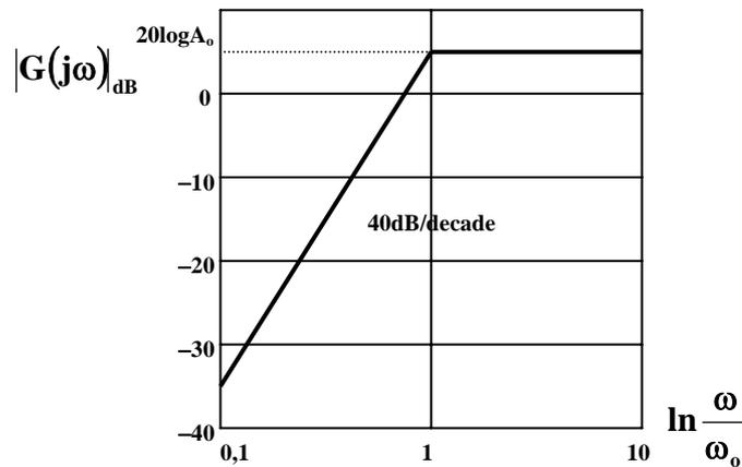
Quando risulta  $Q_o = \frac{1}{\sqrt{2}}$ , la curva reale è il più possibile piatta e la pulsazione di taglio coincide con  $\omega_o$ . Un quadripolo con  $Q_o = \frac{1}{\sqrt{2}} = 0,707$ , viene detto a **banda piatta** o di **Butterworth**.
