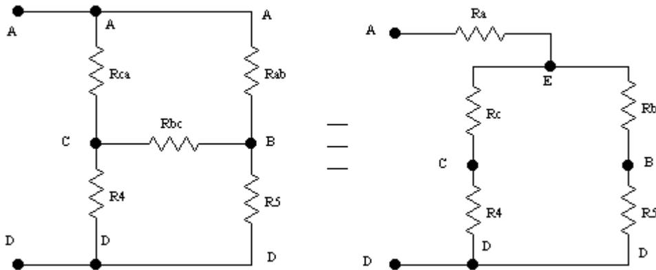
Per potere calcolare la resistenza equivalente di tali circuiti si utilizza la trasformazione stella-triangolo.
