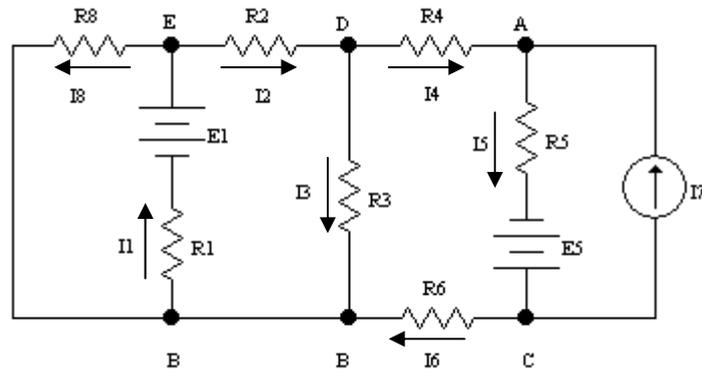
Percorso ACB :  $V_{AB} = +R_5 I_5 - E_5 + R_6 I_6$
