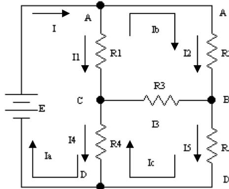
$$\begin{cases} \text{maglia a} & E = R_1(I_a - I_b) + R_4(I_a - I_c) \\ \text{maglia b} & 0 = R_1(I_b - I_a) + R_2I_b + R_3(I_b - I_c) \\ \text{maglia c} & 0 = R_3(I_c - I_b) + R_4(I_c - I_a) + R_5I_c \end{cases} \Rightarrow$$
