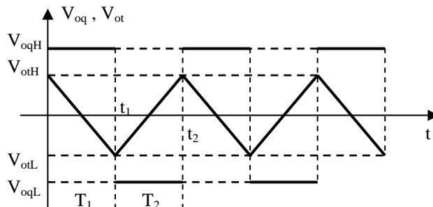
Se al tempo  $t = 0$  la tensione  $V_{oq} = V_{oqH}$ , la tensione  $V_{ot}(t)$  risulta una rampa decrescente (l'integratore è invertente), la cui equazione è:
