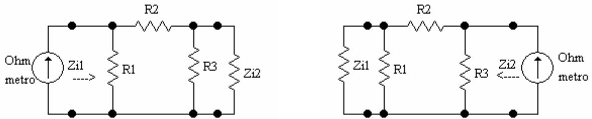
Si misurano  $\bar{Z}_{1a}$ ,  $\bar{Z}_{1c}$ ,  $\bar{Z}_{2a}$ ,  $\bar{Z}_{2c}$ , e si verifica che  $\sqrt{\bar{Z}_{1a} \cdot \bar{Z}_{1c}} = Z_{i1}$  e  $\sqrt{\bar{Z}_{2a} \cdot \bar{Z}_{2c}} = Z_{i2}$ .
