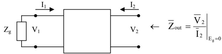
Se si opera a frequenze molto elevate oppure il quadripolo rappresenta una linea di trasmissione, occorre che siano rispettate le **condizioni di adattamento**, ossia  $\bar{Z}_g = \bar{Z}_{in}$  e  $\bar{Z}_u = \bar{Z}_{out}$ .
