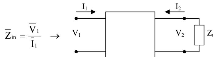
I terminali d'uscita, con ingresso chiuso sul generatore di segnale, si comportano, visti dal carico  $Z_u$ , come un generatore la cui impedenza equivalente si calcola, secondo Thèvenin, come
