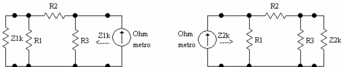
d. se  $R_1 = R_3$ , misura dell'impedenza caratteristica e verifica che  $\bar{Z}_{i1} = \bar{Z}_{i2} = \bar{Z}_{1k} = \bar{Z}_{2k} = \bar{Z}_o$
