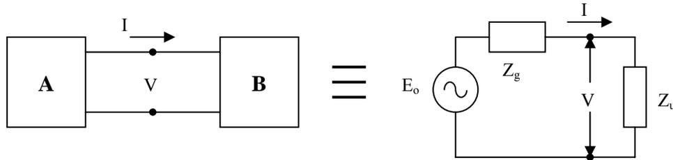
Il circuito B, che assorbe potenza, può essere schematizzato come un utilizzatore, in quanto ai suoi morsetti è applicabile la legge di Ohm  $Z_u = \frac{V}{I}$  (dove V ed I sono valori efficaci).
