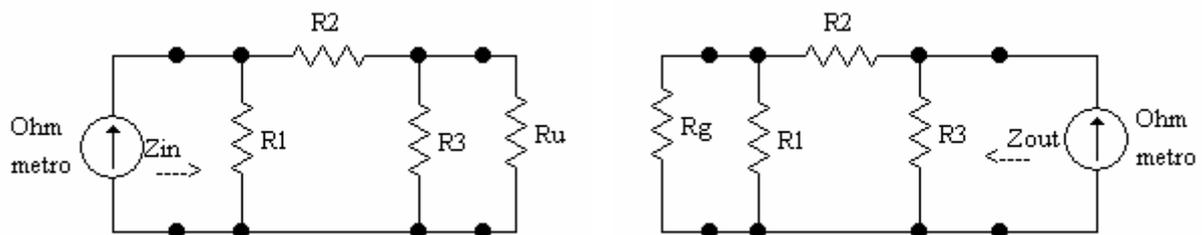
b. misura delle impedenze immagine  $\bar{Z}_{i1}$  e  $\bar{Z}_{i2}$
