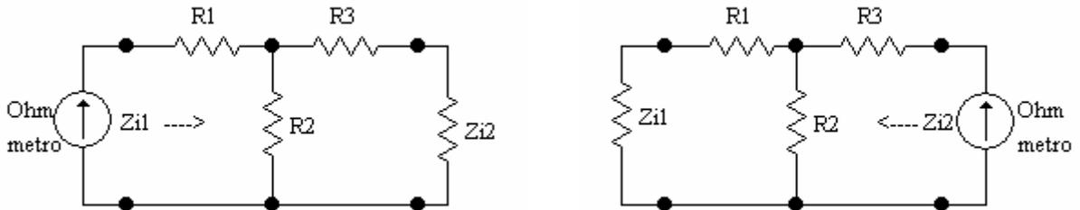
Si misurano  $\bar{Z}_{1a}$ ,  $\bar{Z}_{1c}$ ,  $\bar{Z}_{2a}$ ,  $\bar{Z}_{2c}$ , e si verifica che  $\sqrt{\bar{Z}_{1a} \cdot \bar{Z}_{1c}} = Z_{i1}$  e  $\sqrt{\bar{Z}_{2a} \cdot \bar{Z}_{2c}} = Z_{i2}$ .
