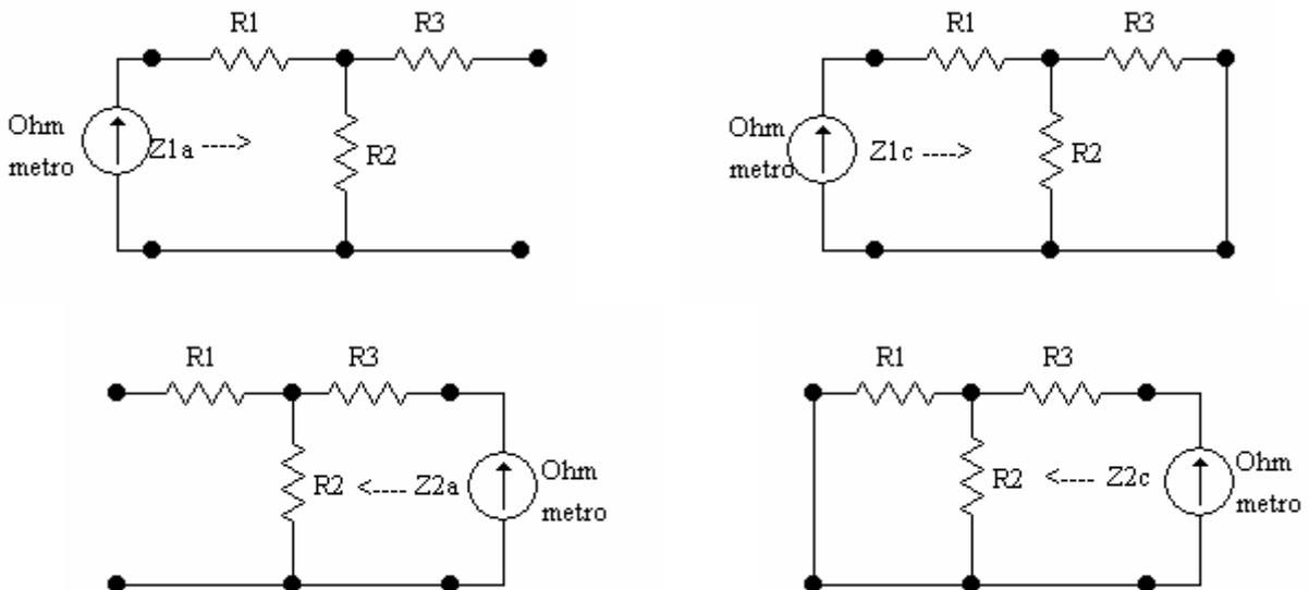
**c. misura delle impedenze iterative  $\bar{Z}_{1k}$  e  $\bar{Z}_{2k}$**
