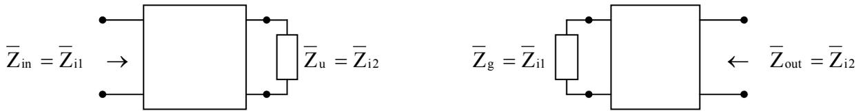
Le impedenze immagine dipendono dalla costituzione del quadripolo e sono determinabili tramite misure di impedenze:
