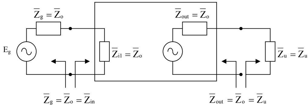
Un quadripolo, chiuso sulla sua impedenza caratteristica è **adattato**, poiché le sue impedenze d'ingresso ( $Z_{in}$ ) e d'uscita ( $Z_{out}$ ) sono uguali a  $Z_0$ .
