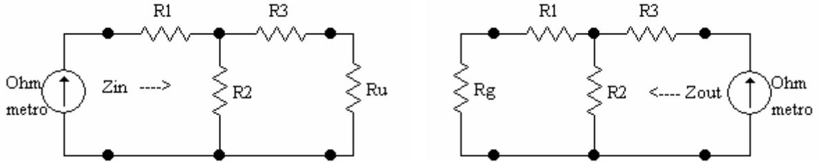
**b. misura delle impedenze immagine  $\bar{Z}_{i1}$  e  $\bar{Z}_{i2}$**
