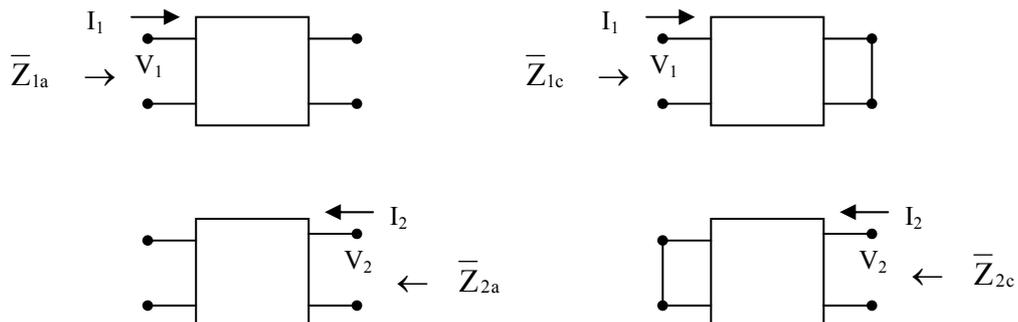
Un quadripolo chiuso sulle proprie impedenze immagine risulta adattato:  $\bar{Z}_g = \bar{Z}_{i1}$  e  $\bar{Z}_u = \bar{Z}_{i2}$ .
