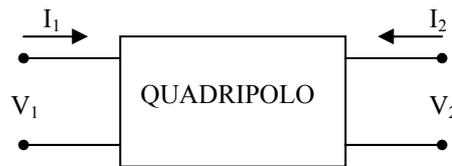
Convenzionalmente si assume come verso positivo delle correnti quello entrante nel quadripolo (sia in ingresso sia in uscita).
