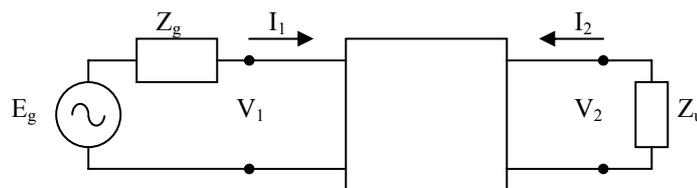
I terminali d'ingresso, con uscita chiusa sul carico  $Z_u$ , visti dal generatore di segnale, si comportano come un carico  $Z_{in}$ , definito come
