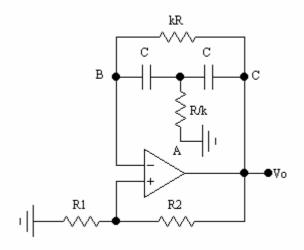
La funzione di trasferimento del T-pontato è minima alla frequenza di risonanza  $f_o = \frac{1}{2\pi RC}$ , per cui tale rete viene impiegata come retroazione negativa. Supponendo ideale l'amplificatore operazionale, si ha  $V_+ = V_-$ , da cui:
