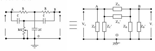
Al fine di semplificare il calcolo del circuito, trasformiamo le due stelle ABO in due triangoli. Le regole di trasformazione sono:
