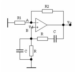
Nel caso ideale gli ingressi non assorbono corrente e  $V_{-} = V_{+}$ .  $V_{-} = \frac{R_{1}}{R_{1} + R_{2}} V_{o}$ ;
