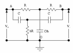
A frequenza zero e a frequenza infinita la rete di Scott non determina alcuno sfasamento tra la tensione d'ingresso e la tensione d'uscita (infatti, a frequenza zero e a frequenza infinita risulta  $V_{\rm o} = V_{\rm o}$ ). Alle basse frequenze prevale l'effetto delle capacità C dei rami in serie, che determinano uno sfasamento positivo; alle alte frequenze prevale quello della capacità C/b di uno dei rami in derivazione, che determina uno sfasamento negativo.
