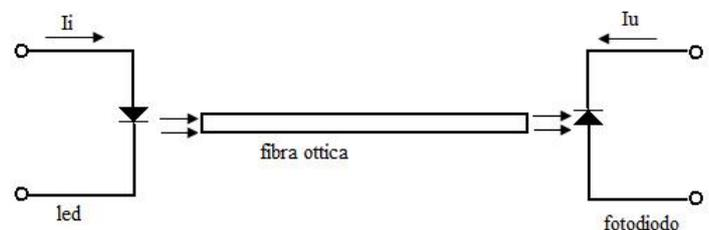
che trasforma l'informazione luminosa nel segnale elettrico  $I_u$ . Una fibra ottica è costituita da un filo molto sottile di quarzo o di epoxy, che può trasmettere da una estremità all'altra un fascio luminoso, con perdita minima anche a notevole distanza.
