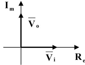
In conclusione, la tensione d'uscita  $V_o$  è in anticipo di  $90^\circ$  su  $V_i$  e la sua ampiezza aumenta con l'aumentare della frequenza, pertanto il derivatore non invertente presenta instabilità alle alte frequenze.
