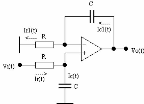
Per lo studio del circuito si tiene conto dell'equipotenzialità degli ingressi,  $V_+ = V_-$ , e che gli ingressi non assorbono corrente,  $I_R = I_C$  e  $I_{R1} = I_{C1}$ .
