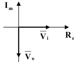
In conclusione, la tensione d'uscita  $V_o$  è in ritardo di  $90^\circ$  su  $V_i$  e la sua ampiezza aumenta con il diminuire della frequenza, pertanto l'integratore non invertente presenta instabilità alle basse frequenze.
