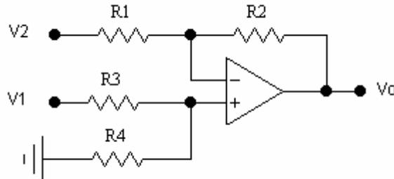
L'uscita  $V_o$  è una combinazione lineare degli ingressi  $V_1$  e  $V_2$ :  $V_o = a_1 V_1 + a_2 V_2$
