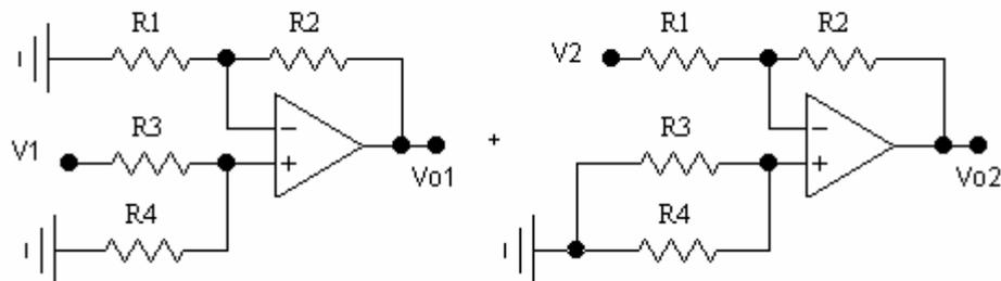
Si cortocircuita a massa  $V_2$  e si calcola  $V_{o1}$ :
