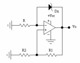
Si ricava la funzione d'uscita tenendo conto dell'equipotenzialità degli ingressi,  $V_- = V_+$ , e che gli ingressi non assorbono corrente.
