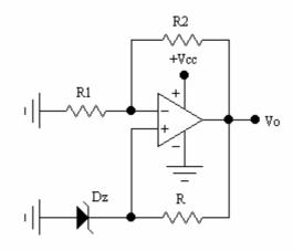
Si ricava la funzione d'uscita tenendo conto dell'equipotenzialità degli ingressi,  $V_- = V_+$ , e che gli ingressi non assorbono corrente.
