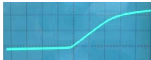
La pendenza della curva caratteristica d'uscita senza carico è  $m_{sc} = 1/1 = 1$ ; la pendenza della curva caratteristica d'uscita con carico è  $m_{cc} = 0,8/1 = 0,8$ .
