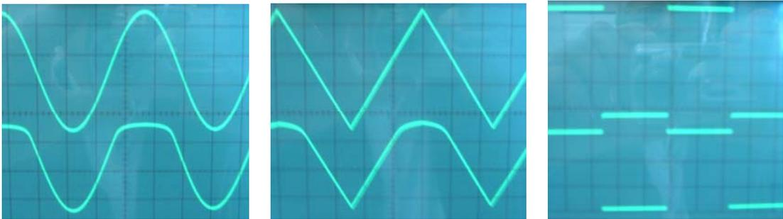
**Curva caratteristica d'uscita (sinusoidale 2volt/div e quadra 5volt/div)**
