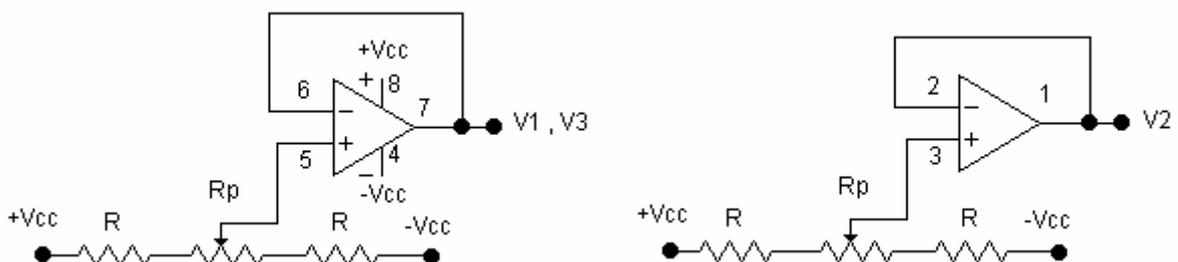
**Valori:**  $R = 1k\Omega$  ;  $R_P = 10k\Omega$  10 giri ;  $V_{CC} = \pm 12V$ .
