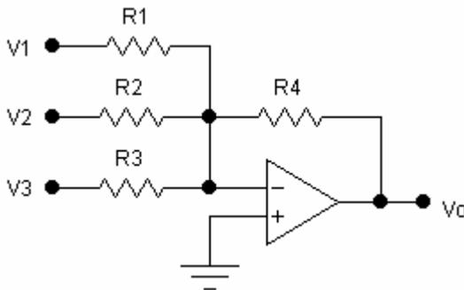
$$V_o = -\frac{R_4}{R_1} V_1 - \frac{R_4}{R_2} V_2 - \frac{R_4}{R_3} V_3$$
