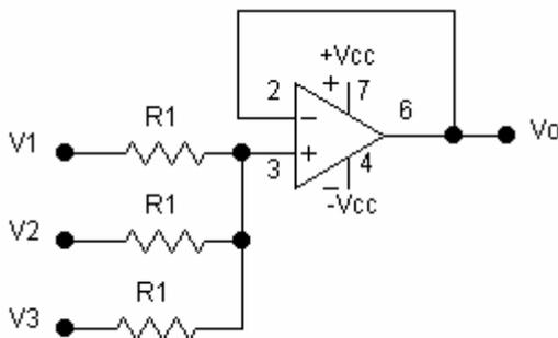
$$V_o = \frac{V_1 + V_2 + V_3}{3}$$
