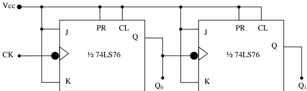
Si utilizzano due flip-flop JK negative edge-triggered, con  $J = K = 1$ , ossia in configurazione T, in modo tale che le uscite  $Q_0$  e  $Q_1$  commutano ogni qual volta all'ingresso di clock è presente un fronte di discesa.
