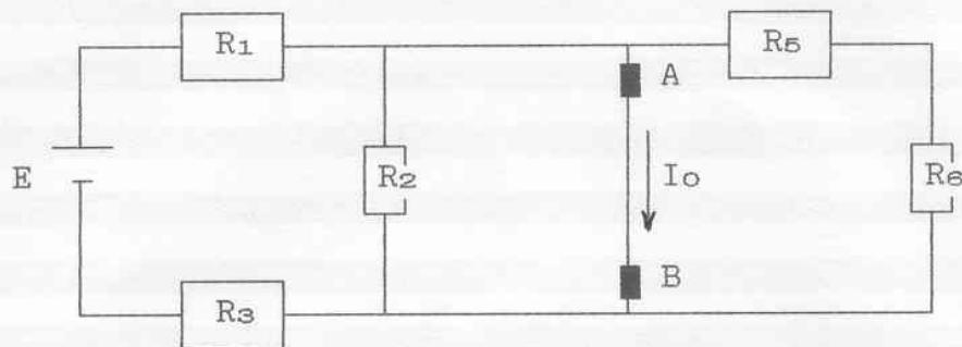
$$I_O = \frac{E}{R_1 + R_3} = \frac{231,15}{4,7 \cdot 10^3 + 3,3 \cdot 10^3} = 28,89 \text{ mA}$$
