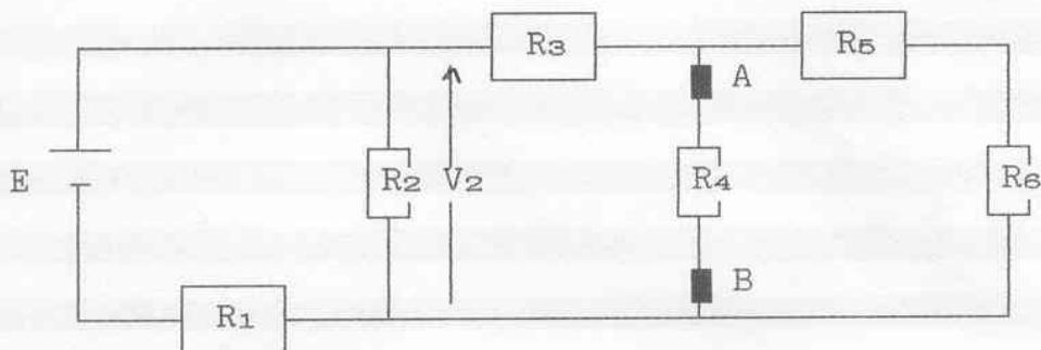
$$\begin{aligned}R_1 &= 2,2 \text{ k}\Omega \\R_2 &= 6,8 \text{ k}\Omega \\R_3 &= 1 \text{ k}\Omega \\R_4 &= 3,3 \text{ k}\Omega \\R_5 &= 4,7 \text{ k}\Omega \\R_6 &= 5,6 \text{ k}\Omega \\V_2 &= 5 \text{ V}\end{aligned}$$
