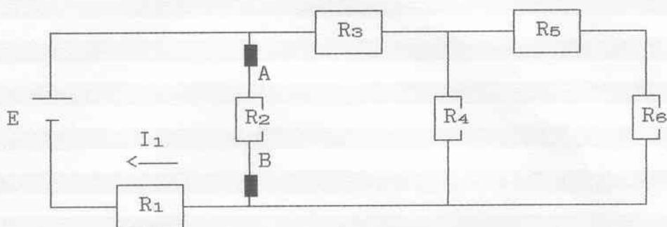
$$\begin{aligned}R_1 &= 1 \text{ k}\Omega \\R_2 &= 2,2 \text{ k}\Omega \\R_3 &= 3,3 \text{ k}\Omega \\R_4 &= 4,7 \text{ k}\Omega \\R_5 &= 5,6 \text{ k}\Omega \\R_6 &= 6,8 \text{ k}\Omega \\I_1 &= 10 \text{ mA}\end{aligned}$$
