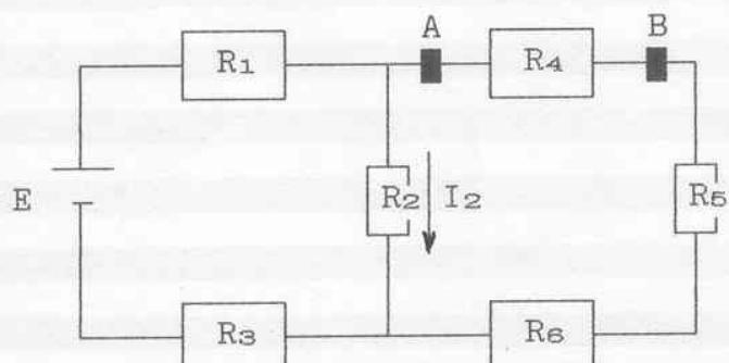
$$\begin{aligned}R_1 &= 3,3 \text{ k}\Omega & R_2 &= 4,7 \text{ k}\Omega \\R_3 &= 5,6 \text{ k}\Omega & R_4 &= 6,8 \text{ k}\Omega \\R_5 &= 1 \text{ k}\Omega & R_6 &= 2,2 \text{ k}\Omega \\I_2 &= 10 \text{ mA}\end{aligned}$$
