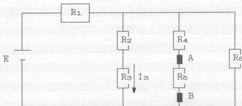
$$\begin{aligned}R_1 &= 6,8 \text{ k}\Omega \\R_2 &= 1 \text{ k}\Omega \\R_3 &= 5,6 \text{ k}\Omega \\R_4 &= 4,7 \text{ k}\Omega \\R_5 &= 3,3 \text{ k}\Omega \\R_6 &= 2,2 \text{ k}\Omega\end{aligned}$$
