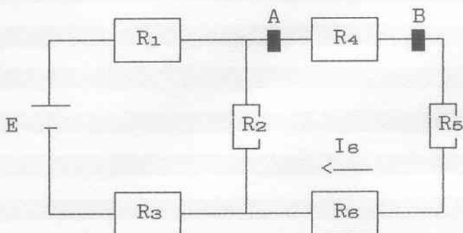
$$\begin{aligned}R_1 &= 5,6 \text{ K}\Omega & R_2 &= 3,3 \text{ K}\Omega \\R_3 &= 4,7 \text{ K}\Omega & R_4 &= 6,8 \text{ K}\Omega \\R_5 &= 1 \text{ K}\Omega & R_6 &= 2,2 \text{ K}\Omega \\I_6 &= 1 \text{ mA}\end{aligned}$$
