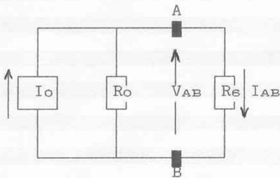
$$R_{os} = \frac{R_o * R_s}{R_o + R_s} = \frac{1,37 \cdot 10^3 * 3,3 \cdot 10^3}{1,37 \cdot 10^3 + 3,3 \cdot 10^3} = 0,97 \text{ k}\Omega$$
