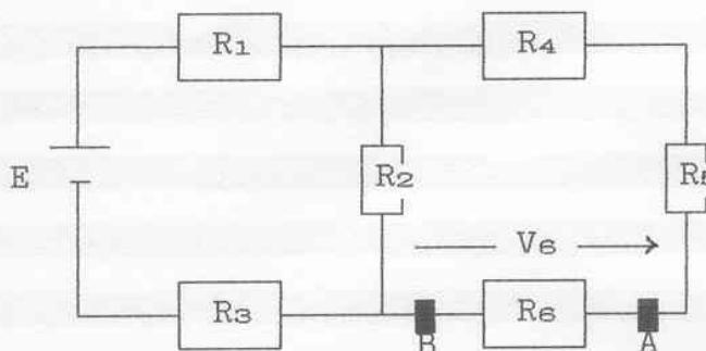
$$\begin{aligned} R_1 &= 2,2 \text{ k}\Omega & R_2 &= 6,8 \text{ k}\Omega \\ R_3 &= 1 \text{ k}\Omega & R_4 &= 3,3 \text{ k}\Omega \\ R_5 &= 4,7 \text{ k}\Omega & R_6 &= 5,6 \text{ k}\Omega \\ V_6 &= 3 \text{ V} \end{aligned}$$
