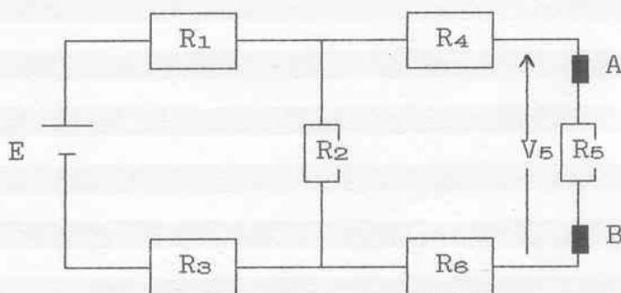
$$\begin{aligned}R_1 &= 5,6 \text{ K}\Omega & R_2 &= 6,8 \text{ K}\Omega \\R_3 &= 1 \text{ K}\Omega & R_4 &= 2,2 \text{ K}\Omega \\R_5 &= 3,3 \text{ K}\Omega & R_6 &= 4,7 \text{ K}\Omega \\V_5 &= 1 \text{ V}\end{aligned}$$
