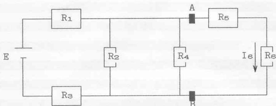
$$\begin{aligned}R_1 &= 3,3 \text{ k}\Omega \\R_2 &= 6,8 \text{ k}\Omega \\R_3 &= 1 \text{ k}\Omega \\R_4 &= 2,2 \text{ k}\Omega \\R_5 &= 5,6 \text{ k}\Omega \\R_6 &= 4,7 \text{ k}\Omega \\I_6 &= 1 \text{ mA}\end{aligned}$$
