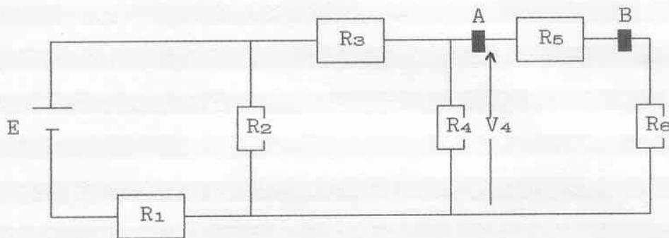
$$\begin{aligned}R_1 &= 3,3 \text{ k}\Omega \\R_2 &= 2,2 \text{ k}\Omega \\R_3 &= 1 \text{ k}\Omega \\R_4 &= 6,8 \text{ k}\Omega \\R_5 &= 5,6 \text{ k}\Omega \\R_6 &= 4,7 \text{ k}\Omega \\V_4 &= 1 \text{ V}\end{aligned}$$
