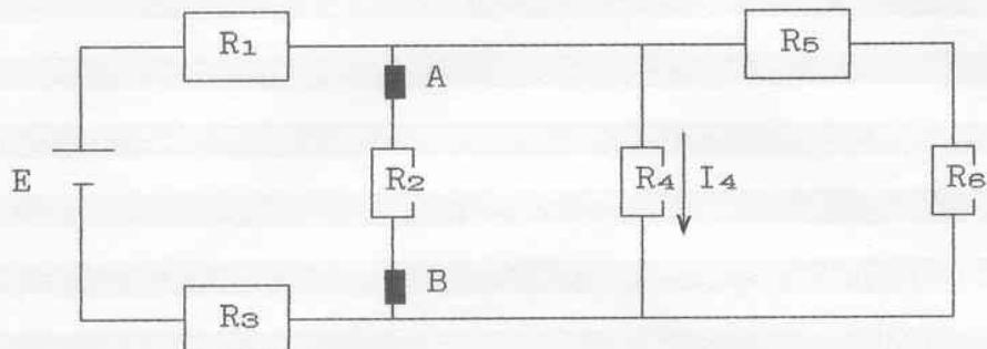
$$\begin{aligned}R_1 &= 3,3 \text{ k}\Omega \\R_2 &= 1 \text{ k}\Omega \\R_3 &= 2,2 \text{ k}\Omega \\R_4 &= 6,8 \text{ k}\Omega \\R_5 &= 4,7 \text{ k}\Omega \\R_6 &= 5,6 \text{ k}\Omega \\I_4 &= 10\text{mA}\end{aligned}$$
