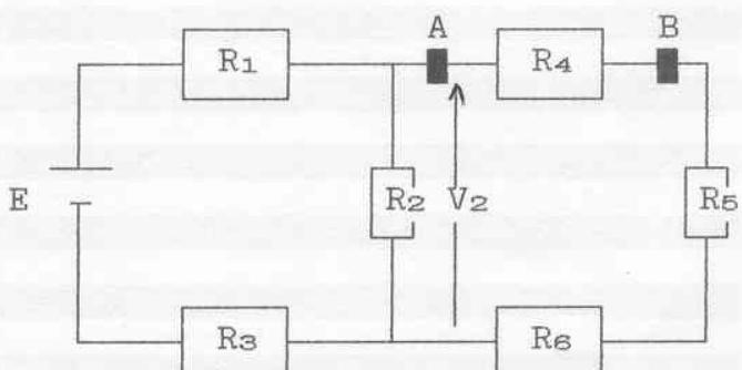
$$\begin{aligned}R_1 &= 3,3 \text{ K}\Omega & R_2 &= 1 \text{ K}\Omega \\R_3 &= 2,2 \text{ K}\Omega & R_4 &= 6,8 \text{ K}\Omega \\R_5 &= 4,7 \text{ K}\Omega & R_6 &= 5,6 \text{ K}\Omega \\V_2 &= 1 \text{ V}\end{aligned}$$
