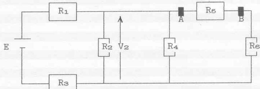
$$\begin{aligned}R_1 &= 2,2 \text{ K}\Omega \\R_2 &= 6,8 \text{ K}\Omega \\R_3 &= 5,6 \text{ K}\Omega \\R_4 &= 4,7 \text{ K}\Omega \\R_5 &= 3,3 \text{ K}\Omega \\R_6 &= 1 \text{ K}\Omega \\V_2 &= 4 \text{ V}\end{aligned}$$
