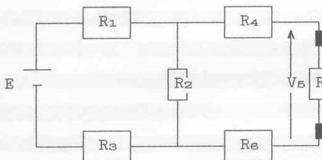
$$\begin{aligned} R_1 &= 5,6 \text{ k}\Omega & R_2 &= 6,8 \text{ k}\Omega \\ R_3 &= 1 \text{ k}\Omega & R_4 &= 2,2 \text{ k}\Omega \\ R_5 &= 3,3 \text{ k}\Omega & R_6 &= 4,7 \text{ k}\Omega \\ V_5 &= 1 \text{ V} \end{aligned}$$
