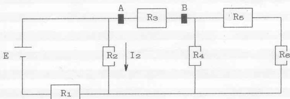
$$\begin{aligned}R_1 &= 3,3 \text{ k}\Omega \\R_2 &= 4,7 \text{ k}\Omega \\R_3 &= 5,6 \text{ k}\Omega \\R_4 &= 6,8 \text{ k}\Omega \\R_5 &= 1 \text{ k}\Omega \\R_6 &= 2,2 \text{ k}\Omega \\I_2 &= 10 \text{ mA}\end{aligned}$$
