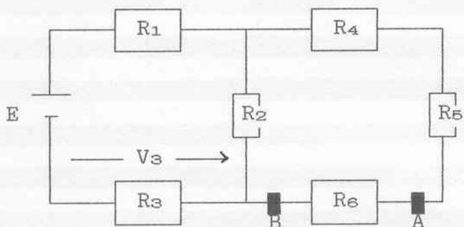
$$\begin{aligned}R_1 &= 3,3 \text{ K}\Omega & R_2 &= 2,2 \text{ K}\Omega \\R_3 &= 1 \text{ K}\Omega & R_4 &= 6,8 \text{ K}\Omega \\R_5 &= 5,6 \text{ K}\Omega & R_6 &= 4,7 \text{ K}\Omega \\V_3 &= 1 \text{ V}\end{aligned}$$
