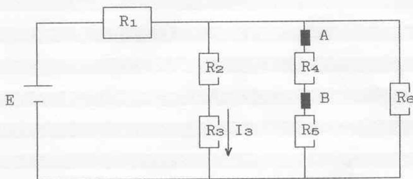
$$\begin{aligned}R_1 &= 3,3 \text{ k}\Omega \\R_2 &= 4,7 \text{ k}\Omega \\R_3 &= 5,6 \text{ k}\Omega \\R_4 &= 6,8 \text{ k}\Omega \\R_5 &= 1 \text{ k}\Omega \\R_6 &= 2,2 \text{ k}\Omega \\I_s &= 10 \text{ mA}\end{aligned}$$
