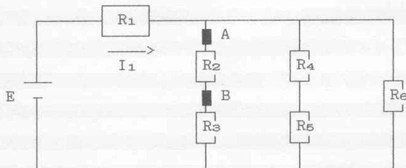
$$\begin{aligned}R_1 &= 1 \text{ k}\Omega \\R_2 &= 2,2 \text{ k}\Omega \\R_3 &= 3,3 \text{ k}\Omega \\R_4 &= 4,7 \text{ k}\Omega \\R_5 &= 5,6 \text{ k}\Omega \\R_6 &= 6,8 \text{ k}\Omega\end{aligned}$$
