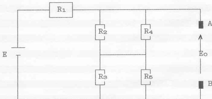
$$E_o = \frac{R_{25}}{R_1 + R_{25}} * E = \frac{3,63 \cdot 10^3}{2,2 \cdot 10^3 + 3,63 \cdot 10^3} * 39,3 = 24,47 \text{ V}$$
