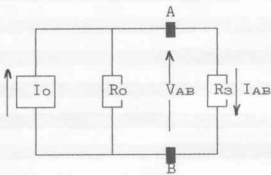
$$R_{o3} = \frac{R_O * R_3}{R_O + R_3} = \frac{1,41 \cdot 10^3 * 5,6 \cdot 10^3}{1,41 \cdot 10^3 + 5,6 \cdot 10^3} = 1,12 \text{ k}\Omega$$
