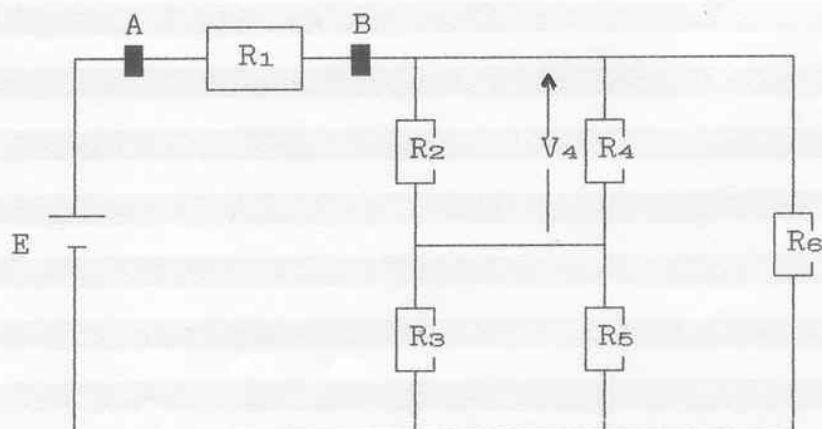
$$\begin{aligned}R_1 &= 4,7 \text{ k}\Omega \\R_2 &= 2,2 \text{ k}\Omega \\R_3 &= 3,3 \text{ k}\Omega \\R_4 &= 1 \text{ k}\Omega \\R_5 &= 6,8 \text{ k}\Omega \\R_6 &= 5,6 \text{ k}\Omega \\V_4 &= 2 \text{ V}\end{aligned}$$
