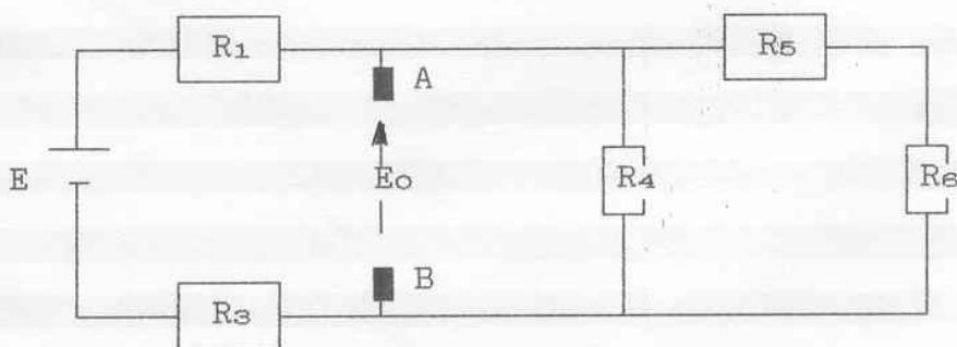
$$R_{46} = \frac{R_4 * (R_5 + R_6)}{R_4 + R_5 + R_6} = \frac{6,8 \cdot 10^3 * 10,3 \cdot 10^3}{6,8 \cdot 10^3 + 10,3 \cdot 10^3} = 4,096 \text{ k}\Omega$$
