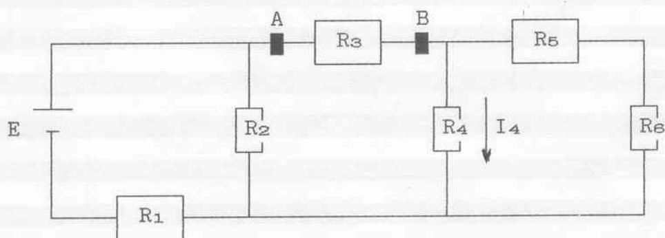
$$\begin{aligned}R_1 &= 4,7 \text{ k}\Omega \\R_2 &= 2,2 \text{ k}\Omega \\R_3 &= 3,3 \text{ k}\Omega \\R_4 &= 5,6 \text{ k}\Omega \\R_5 &= 6,8 \text{ k}\Omega \\R_6 &= 1 \text{ k}\Omega \\I_4 &= 10 \text{ mA}\end{aligned}$$
