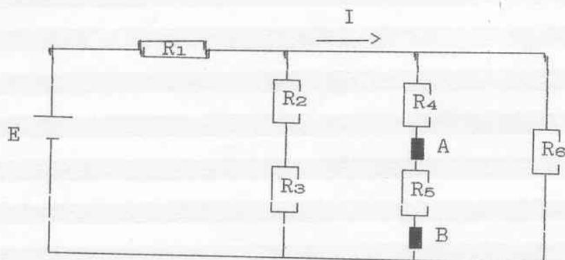
$$\begin{aligned}R_1 &= 5,6 \text{ k}\Omega \\R_2 &= 1 \text{ k}\Omega \\R_3 &= 4,7 \text{ k}\Omega \\R_4 &= 3,3 \text{ k}\Omega \\R_5 &= 2,2 \text{ k}\Omega \\R_6 &= 6,8 \text{ k}\Omega \\I &= 10 \text{ mA}\end{aligned}$$
