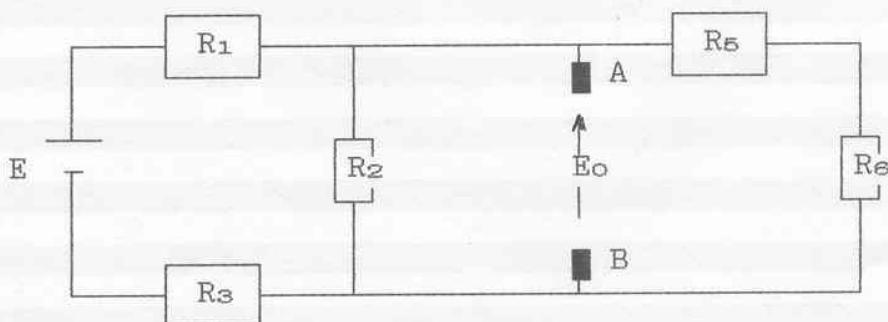
$$R_{26} = \frac{R_2 * (R_5 + R_6)}{R_2 + R_5 + R_6} = \frac{2,2 \cdot 10^3 * 7,8 \cdot 10^3}{2,2 \cdot 10^3 + 7,8 \cdot 10^3} = 1,716 \text{ k}\Omega$$
