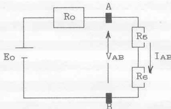
$$I_{AB} = \frac{E_o}{R_o + R_5 + R_6} = \frac{10,38}{1,49 \cdot 10^3 + 5,6 \cdot 10^3 + 3,3 \cdot 10^3} = 1 \text{ mA}$$
