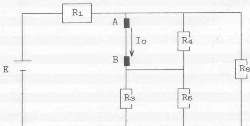
$$R_{36} = \frac{R_{35} * R_6}{R_{35} + R_6} = \frac{2,22*10^3 * 1*10^3}{2,22*10^3 + 1*10^3} = 0,69 \text{ k}\Omega$$
