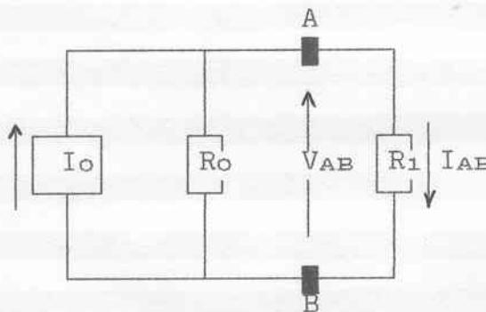
$$R_{o1} = \frac{R_o * R_1}{R_o + R_1} = \frac{2,43 \cdot 10^3 * 3,3 \cdot 10^3}{2,43 \cdot 10^3 + 3,3 \cdot 10^3} = 1,4 \text{ k}\Omega$$
