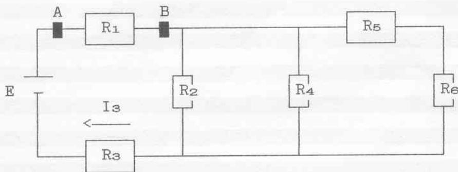
$$\begin{aligned}R_1 &= 3,3 \text{ k}\Omega \\R_2 &= 6,8 \text{ k}\Omega \\R_3 &= 1 \text{ k}\Omega \\R_4 &= 2,2 \text{ k}\Omega \\R_5 &= 5,6 \text{ k}\Omega \\R_6 &= 4,7 \text{ k}\Omega \\I_3 &= 10 \text{ mA}\end{aligned}$$
