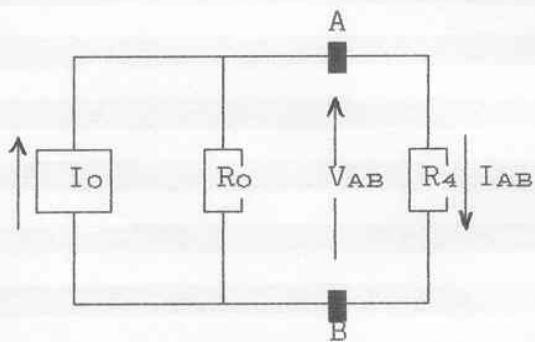
$$R_{O4} = \frac{R_O * R_4}{R_O + R_4} = \frac{1,41 \cdot 10^3 * 5,6 \cdot 10^3}{1,41 \cdot 10^3 + 5,6 \cdot 10^3} = 1,126 \text{ K}\Omega$$
