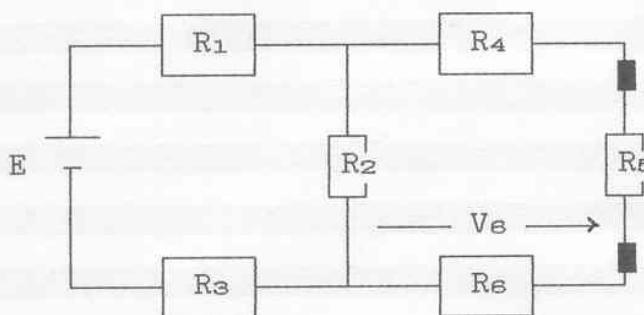
$$\begin{aligned} R_1 &= 2,2 \text{ k}\Omega & R_2 &= 4,7 \text{ k}\Omega \\ R_3 &= 1 \text{ k}\Omega & R_4 &= 2,2 \text{ k}\Omega \\ R_5 &= 6,8 \text{ k}\Omega & R_6 &= 5,6 \text{ k}\Omega \\ V_s &= 2 \text{ V} \end{aligned}$$
