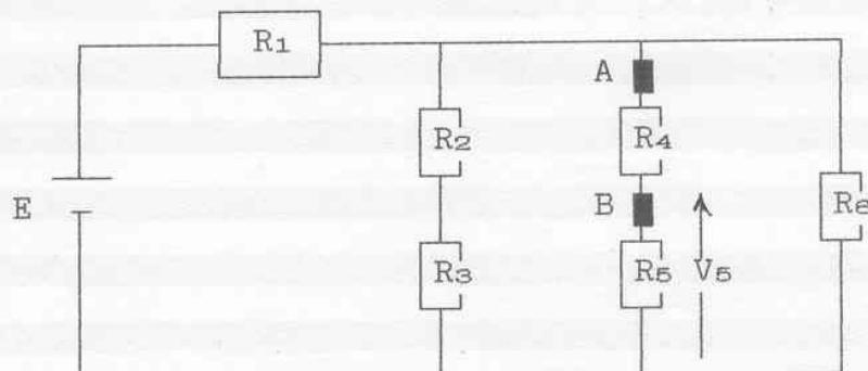
$$\begin{aligned}R_1 &= 5,6 \text{ k}\Omega \\R_2 &= 3,3 \text{ k}\Omega \\R_3 &= 4,7 \text{ k}\Omega \\R_4 &= 6,8 \text{ k}\Omega \\R_5 &= 1 \text{ k}\Omega \\R_6 &= 2,2 \text{ k}\Omega \\V_5 &= 1 \text{ V}\end{aligned}$$
