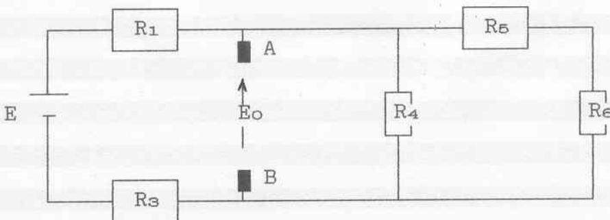
$$R_{46} = \frac{R_4 * (R_5 + R_6)}{R_4 + R_5 + R_6} = \frac{4,7*10^3 * 5,5*10^3}{4,7*10^3 + 5,5*10^3} = 2,53 \text{ K}\Omega$$
