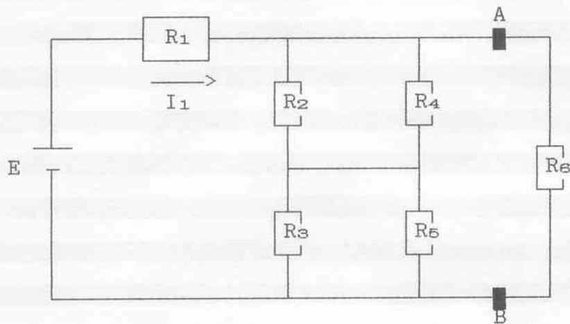
$$\begin{aligned}R_1 &= 2,2 \text{ k}\Omega \\R_2 &= 6,8 \text{ k}\Omega \\R_3 &= 1 \text{ k}\Omega \\R_4 &= 4,7 \text{ k}\Omega \\R_5 &= 5,6 \text{ k}\Omega \\R_6 &= 3,3 \text{ k}\Omega \\I_1 &= 10 \text{ mA}\end{aligned}$$
