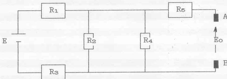
$$R_{24} = \frac{R_2 * R_4}{R_2 + R_4} = \frac{3,3 \cdot 10^3 * 2,2 \cdot 10^3}{3,3 \cdot 10^3 + 2,2 \cdot 10^3} = 1,32 \text{ k}\Omega$$
