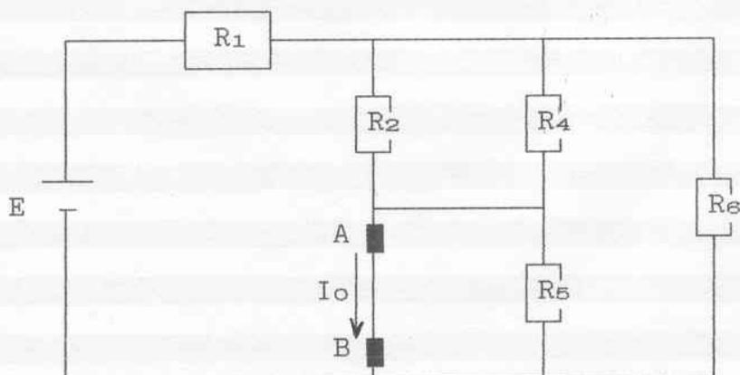
$$R_{26} = \frac{R_{24} * R_6}{R_{24} + R_6} = \frac{0,82*10^3 * 2,2*10^3}{0,82*10^3 + 2,2*10^3} = 0,6 \text{ K}\Omega$$
