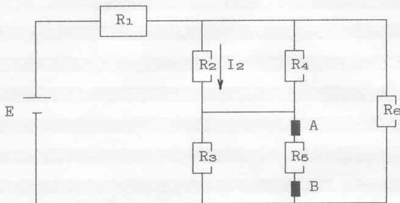
$$\begin{aligned}R_1 &= 3,3 \text{ k}\Omega \\R_2 &= 1 \text{ k}\Omega \\R_3 &= 2,2 \text{ k}\Omega \\R_4 &= 6,8 \text{ k}\Omega \\R_5 &= 4,7 \text{ k}\Omega \\R_6 &= 5,6 \text{ k}\Omega \\I_2 &= 10 \text{ mA}\end{aligned}$$
