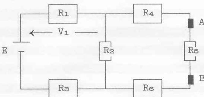
$$\begin{aligned} R_1 &= 4,7 \text{ k}\Omega & R_2 &= 2,2 \text{ k}\Omega \\ R_3 &= 3,3 \text{ k}\Omega & R_4 &= 5,6 \text{ k}\Omega \\ R_5 &= 6,8 \text{ k}\Omega & R_6 &= 1 \text{ k}\Omega \\ V_1 &= 10 \text{ V} \end{aligned}$$
