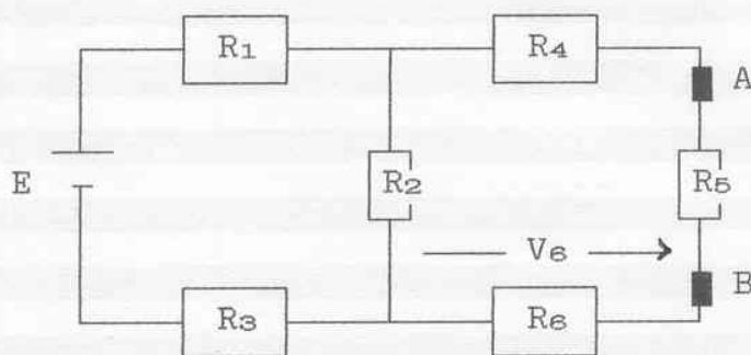
$$\begin{aligned}R_1 &= 2,2 \text{ K}\Omega & R_2 &= 4,7 \text{ K}\Omega \\R_3 &= 1 \text{ K}\Omega & R_4 &= 2,2 \text{ K}\Omega \\R_5 &= 6,8 \text{ K}\Omega & R_6 &= 5,6 \text{ K}\Omega \\V_6 &= 2 \text{ V}\end{aligned}$$
