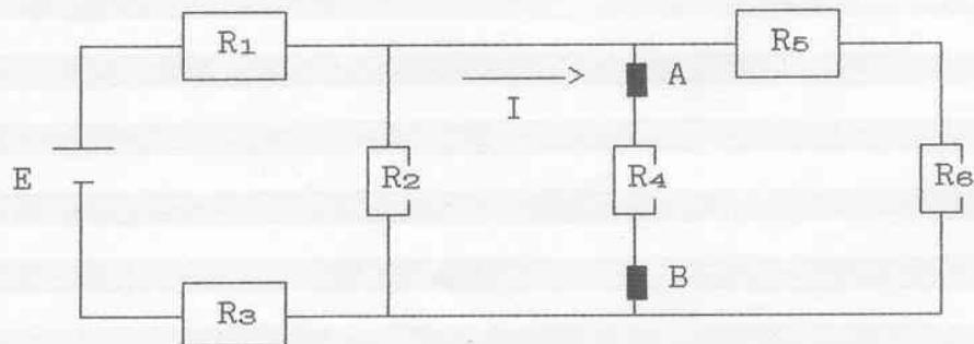
$$\begin{aligned}R_1 &= 4,7 \text{ k}\Omega \\R_2 &= 2,2 \text{ k}\Omega \\R_3 &= 3,3 \text{ k}\Omega \\R_4 &= 5,6 \text{ k}\Omega \\R_5 &= 6,8 \text{ k}\Omega \\R_6 &= 1 \text{ k}\Omega \\I &= 10 \text{ mA}\end{aligned}$$
