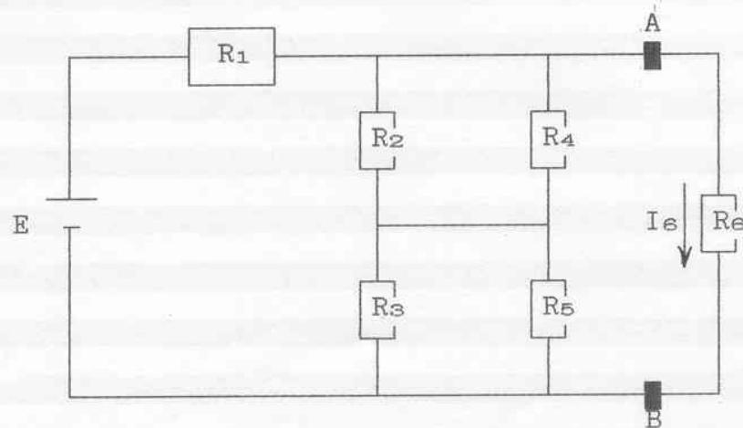
$$\begin{aligned}R_1 &= 3,3 \text{ k}\Omega \\R_2 &= 6,8 \text{ k}\Omega \\R_3 &= 1 \text{ k}\Omega \\R_4 &= 2,2 \text{ k}\Omega \\R_5 &= 5,6 \text{ k}\Omega \\R_6 &= 4,7 \text{ k}\Omega \\I_6 &= 1 \text{ mA}\end{aligned}$$
