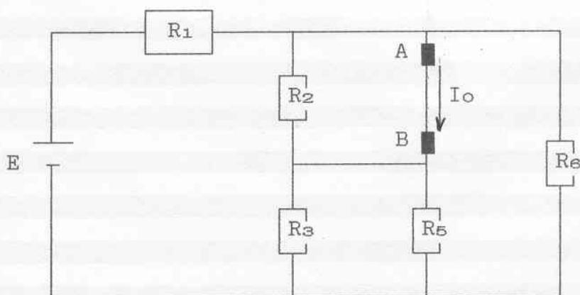
$$R_{36} = \frac{R_{35} * R_6}{R_{35} + R_6} = \frac{2,08 \cdot 10^3 * 1 \cdot 10^3}{2,08 \cdot 10^3 + 1 \cdot 10^3} = 0,675 \text{ k}\Omega$$
