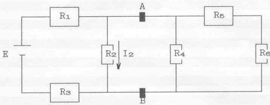
$$\begin{aligned}R_1 &= 4,7 \text{ k}\Omega \\R_2 &= 2,2 \text{ k}\Omega \\R_3 &= 3,3 \text{ k}\Omega \\R_4 &= 1 \text{ k}\Omega \\R_5 &= 6,8 \text{ k}\Omega \\R_6 &= 5,6 \text{ k}\Omega \\I_2 &= 1 \text{ mA}\end{aligned}$$
