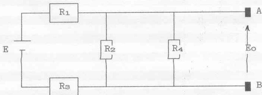
$$R_{24} = \frac{R_2 * R_4}{R_2 + R_4} = \frac{6,8 \cdot 10^3 * 4,7 \cdot 10^3}{6,8 \cdot 10^3 + 4,7 \cdot 10^3} = 2,78 \text{ k}\Omega$$
