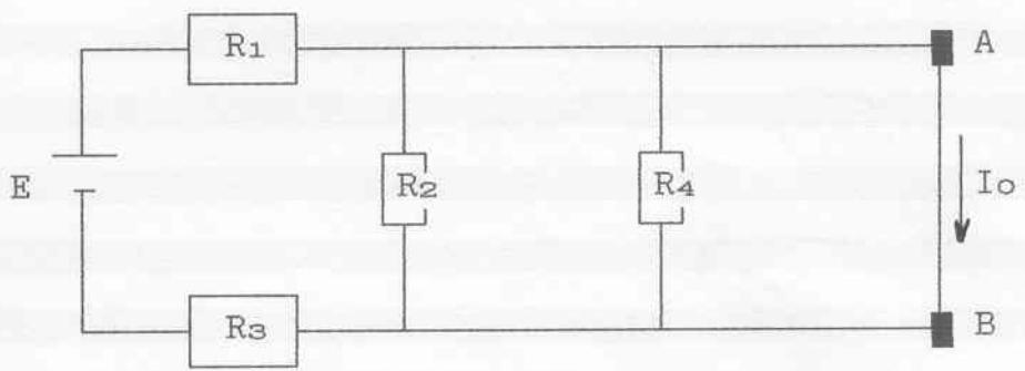
$$I_o = \frac{E}{R_1 + R_3} = \frac{22,34}{2,2 \cdot 10^3 + 1 \cdot 10^3} = 6,98 \text{ mA}$$
