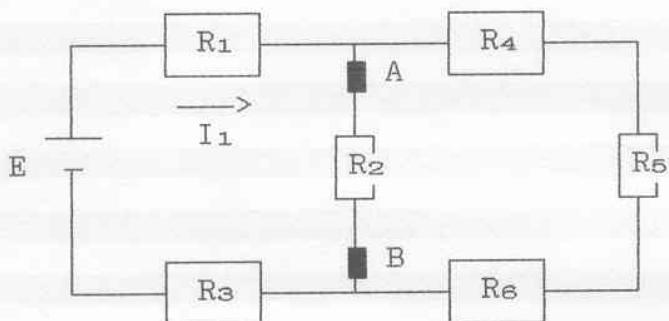
$$\begin{aligned}R_1 &= 1 \text{ k}\Omega & R_2 &= 2,2 \text{ k}\Omega \\R_3 &= 3,3 \text{ k}\Omega & R_4 &= 4,7 \text{ k}\Omega \\R_5 &= 5,6 \text{ k}\Omega & R_6 &= 6,8 \text{ k}\Omega \\I_1 &= 10 \text{ mA}\end{aligned}$$
