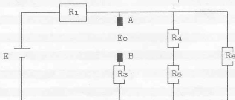
$$R_{46} = \frac{R_6 * (R_4 + R_5)}{R_6 + R_4 + R_5} = \frac{5,6 \cdot 10^3 * 8 \cdot 10^3}{5,6 \cdot 10^3 + 8 \cdot 10^3} = 3,29 \text{ k}\Omega$$
