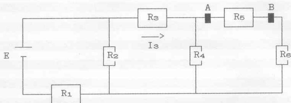
$$\begin{aligned}R_1 &= 5,6 \text{ k}\Omega \\R_2 &= 3,3 \text{ k}\Omega \\R_3 &= 4,7 \text{ k}\Omega \\R_4 &= 6,8 \text{ k}\Omega \\R_5 &= 1 \text{ k}\Omega \\R_6 &= 2,2 \text{ k}\Omega \\I_s &= 10 \text{ mA}\end{aligned}$$
