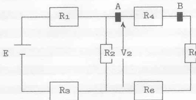
$$\begin{aligned} R_1 &= 3,3 \text{ k}\Omega & R_2 &= 1 \text{ k}\Omega \\ R_3 &= 2,2 \text{ k}\Omega & R_4 &= 6,8 \text{ k}\Omega \\ R_5 &= 4,7 \text{ k}\Omega & R_6 &= 5,6 \text{ k}\Omega \\ V_2 &= 1 \text{ V} \end{aligned}$$
