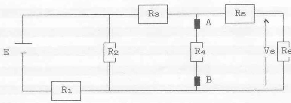
$$\begin{aligned}R_1 &= 5,6 \text{ k}\Omega \\R_2 &= 6,8 \text{ k}\Omega \\R_3 &= 1 \text{ k}\Omega \\R_4 &= 2,2 \text{ k}\Omega \\R_5 &= 3,3 \text{ k}\Omega \\R_6 &= 4,7 \text{ k}\Omega \\V_s &= 1 \text{ V}\end{aligned}$$
