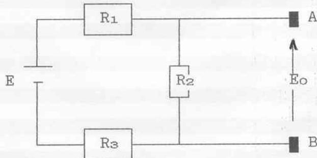
$$E_o = \frac{R_2}{R_1 + R_2 + R_3} * E = \frac{2,2 \cdot 10^3}{4,7 \cdot 10^3 + 2,2 \cdot 10^3 + 3,3 \cdot 10^3} * 29,23 = 6,3 \text{ V}$$
