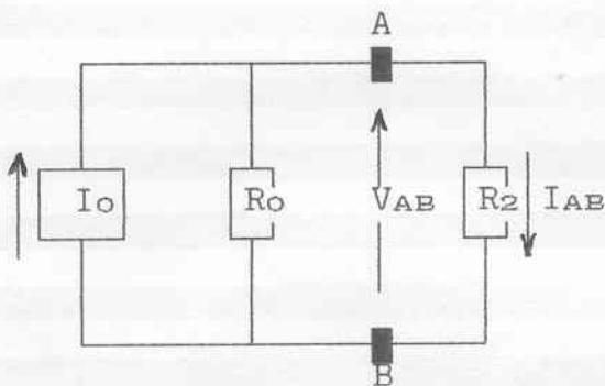
$$R_{o2} = \frac{R_o * R_2}{R_o + R_2} = \frac{2,35 \cdot 10^3 * 1 \cdot 10^3}{2,35 \cdot 10^3 + 1 \cdot 10^3} = 0,7 \text{ k}\Omega$$
