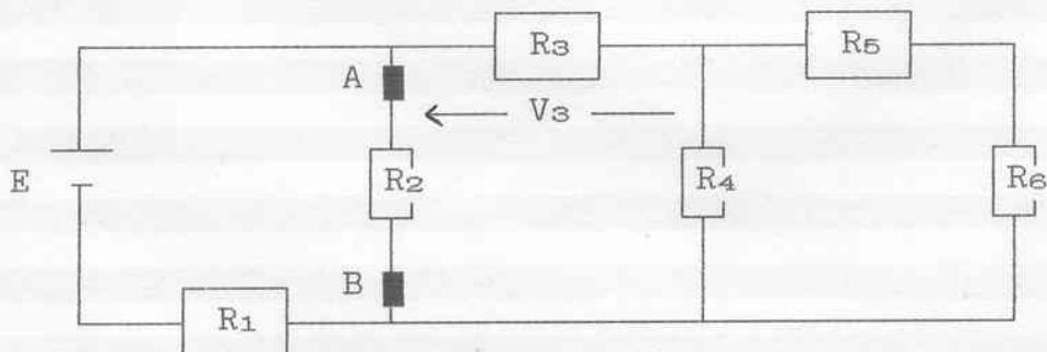
$$\begin{aligned}R_1 &= 3,3 \text{ k}\Omega \\R_2 &= 1 \text{ k}\Omega \\R_3 &= 2,2 \text{ k}\Omega \\R_4 &= 6,8 \text{ k}\Omega \\R_5 &= 4,7 \text{ k}\Omega \\R_6 &= 5,6 \text{ k}\Omega \\V_3 &= 1 \text{ V}\end{aligned}$$
