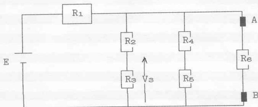
$$\begin{aligned}R_1 &= 1 \text{ k}\Omega \\R_2 &= 3,3 \text{ k}\Omega \\R_3 &= 4,7 \text{ k}\Omega \\R_4 &= 2,2 \text{ k}\Omega \\R_5 &= 6,8 \text{ k}\Omega \\R_6 &= 5,6 \text{ k}\Omega \\V_3 &= 1 \text{ V}\end{aligned}$$
