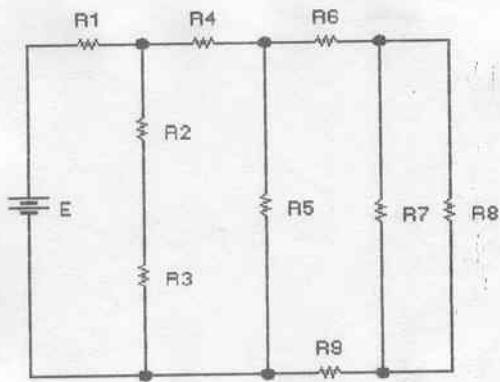
$$E = 100 \text{ V} ; R_1 = 1 \text{ K}\Omega ; R_2 = 4,7 \text{ K}\Omega ; R_3 = 3,9 \text{ K}\Omega ; R_4 = 3,3 \text{ K}\Omega ; R_5 = 1 \text{ K}\Omega ; R_6 = 1,5 \text{ K}\Omega ; R_7 = 6,8 \text{ K}\Omega ; R_8 = 1 \text{ K}\Omega ; R_9 = 4,7 \text{ K}\Omega .$$
