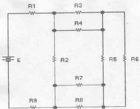
$$E = 100 \text{ V} ; \quad R_1 = 1 \text{ K}\Omega ; \quad R_2 = 4,7 \text{ K}\Omega ; \quad R_3 = 3,9 \text{ K}\Omega ; \quad R_4 = 3,3 \text{ K}\Omega ; \quad R_5 = 1 \text{ K}\Omega ; \\ R_6 = 1,5 \text{ K}\Omega ; \quad R_7 = 6,8 \text{ K}\Omega ; \quad R_8 = 1 \text{ K}\Omega ; \quad R_9 = 4,7 \text{ K}\Omega .$$
