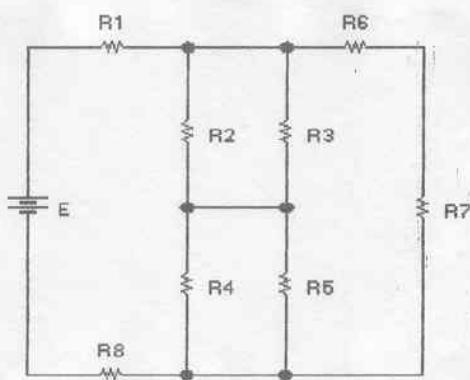
$$E = 100 \text{ V} ; \quad R_1 = 1 \text{ K}\Omega ; \quad R_2 = 4,7 \text{ K}\Omega ; \quad R_3 = 3,9 \text{ K}\Omega ; \quad R_4 = 3,3 \text{ K}\Omega ; \quad R_5 = 1 \text{ K}\Omega ;$$
