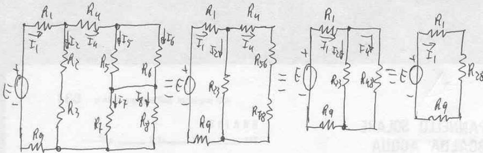
$$1_0 - R_{23} = R_2 + R_3 = 4,7 \cdot 10^3 + 3,9 \cdot 10^3 = 8,6 \text{ k}\Omega; R_{56} = \frac{R_5 R_6}{R_5 + R_6} = \frac{3 \cdot 10^3 \cdot 1,5 \cdot 10^3}{3 \cdot 10^3 + 1,5 \cdot 10^3} = 0,6 \text{ k}\Omega; R_{78} = \frac{R_7 R_8}{R_7 + R_8} = \frac{6,8 \cdot 10^3 \cdot 1 \cdot 10^3}{6,8 \cdot 10^3 + 1 \cdot 10^3} = 0,87 \text{ k}\Omega$$
