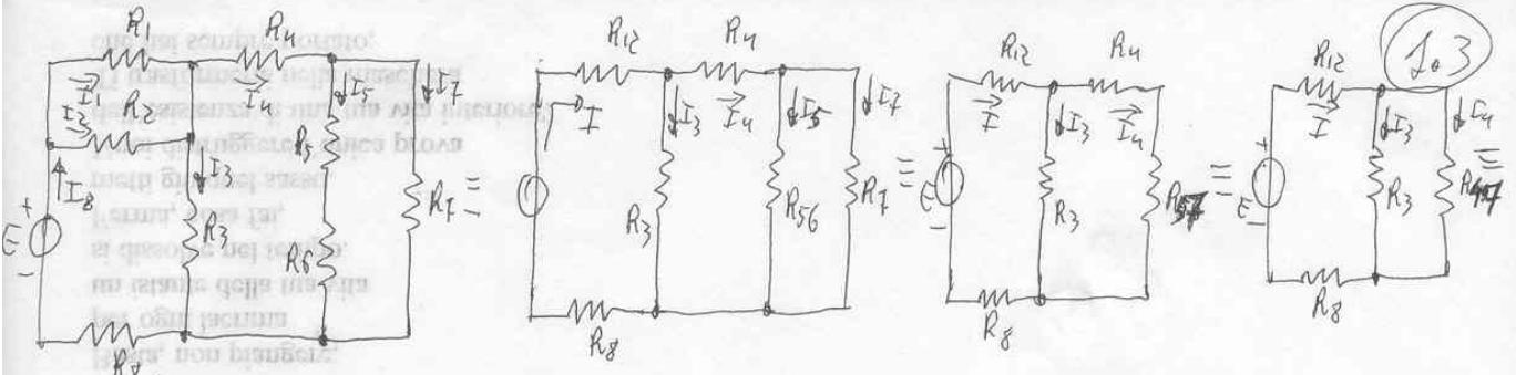
$$I_0 = R_{12} = \frac{R_{12} \cdot R_2}{R_1 + R_2} = \frac{1 \cdot 10^3 \cdot 4,17 \cdot 10^3}{1 \cdot 10^3 + 4,17 \cdot 10^3} = 0,82 \text{ kA} ; R_{56} = R_5 + R_6 = 1 \cdot 10^3 + 1,5 \cdot 10^3 = 2,5 \text{ kA}$$
