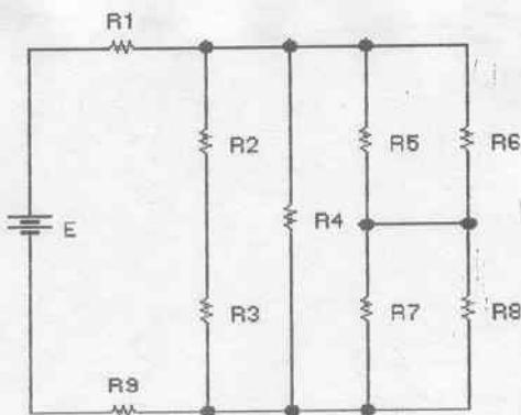
$$E = 100 \text{ V} ; \quad R_1 = 1 \text{ K}\Omega ; \quad R_2 = 4,7 \text{ K}\Omega ; \quad R_3 = 3,9 \text{ K}\Omega ; \quad R_4 = 3,3 \text{ K}\Omega ; \quad R_5 = 1 \text{ K}\Omega ;$$
