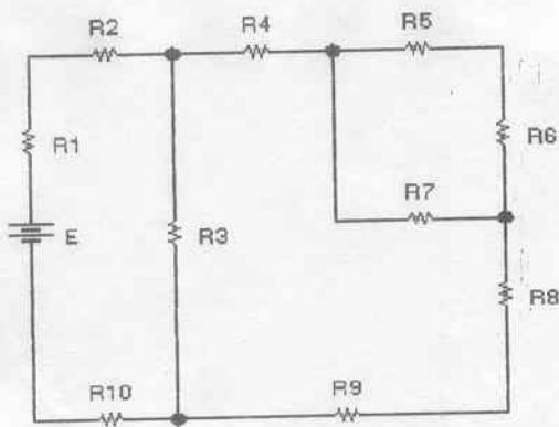
$$E = 100 \text{ V} ; R_1 = 1 \text{ K}\Omega ; R_2 = 4,7 \text{ K}\Omega ; R_3 = 3,9 \text{ K}\Omega ; R_4 = 3,3 \text{ K}\Omega ; R_5 = 1 \text{ K}\Omega ; \\ R_6 = 1,5 \text{ K}\Omega ; R_7 = 6,8 \text{ K}\Omega ; R_8 = 1 \text{ K}\Omega ; R_9 = 4,7 \text{ K}\Omega ; R_{10} = 2,2 \text{ K}\Omega .$$
