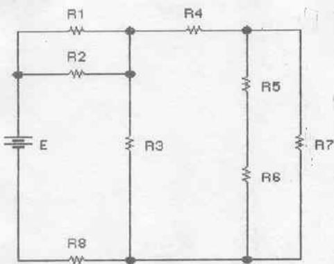
$$E = 100 \text{ V} ; \quad R_1 = 1 \text{ K}\Omega ; \quad R_2 = 4,7 \text{ K}\Omega ; \quad R_3 = 3,9 \text{ K}\Omega ; \quad R_4 = 3,3 \text{ K}\Omega ; \quad R_5 = 1 \text{ K}\Omega ; \\ R_6 = 1,5 \text{ K}\Omega ; \quad R_7 = 6,8 \text{ K}\Omega ; \quad R_8 = 1 \text{ K}\Omega .$$
