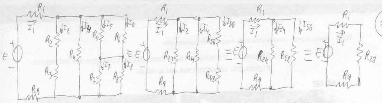
$$1.- R_{23} = R_2 + R_3 = 4,7 \cdot 10^3 + 3,9 \cdot 10^3 = 8,6 \text{ k}\Omega; R_{56} = \frac{R_5 R_6}{R_5 + R_6} = \frac{1 \cdot 10^3 \cdot 1,5 \cdot 10^3}{1 \cdot 10^3 + 1,5 \cdot 10^3} = 0,6 \text{ k}\Omega$$
