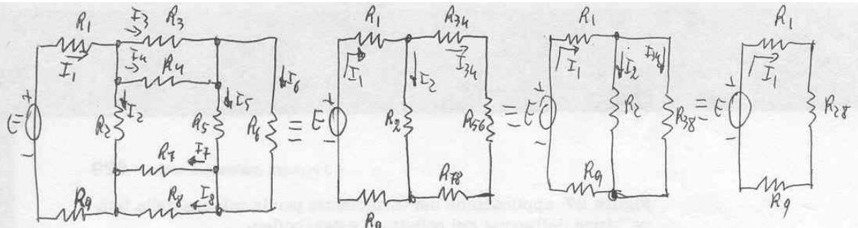
$$1.- R_{34} = \frac{R_3 R_4}{R_3 + R_4} = \frac{3,9 \cdot 10^3 \cdot 3,3 \cdot 10^3}{3,9 \cdot 10^3 + 3,3 \cdot 10^3} = 1,79 \text{ k}\Omega ; R_{56} = \frac{R_5 R_6}{R_5 + R_6} = \frac{1 \cdot 10^3 \cdot 1,5 \cdot 10^3}{1 \cdot 10^3 + 1,5 \cdot 10^3} = 0,6 \text{ k}\Omega ;$$
