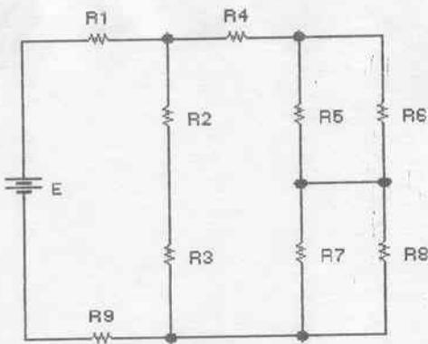
$$E = 100 \text{ V} ; R_1 = 1 \text{ K}\Omega ; R_2 = 4,7 \text{ K}\Omega ; R_3 = 3,9 \text{ K}\Omega ; R_4 = 3,3 \text{ K}\Omega ; R_5 = 1 \text{ K}\Omega ; R_6 = 1,5 \text{ K}\Omega ; R_7 = 6,8 \text{ K}\Omega ; R_8 = 1 \text{ K}\Omega ; R_9 = 4,7 \text{ K}\Omega .$$
