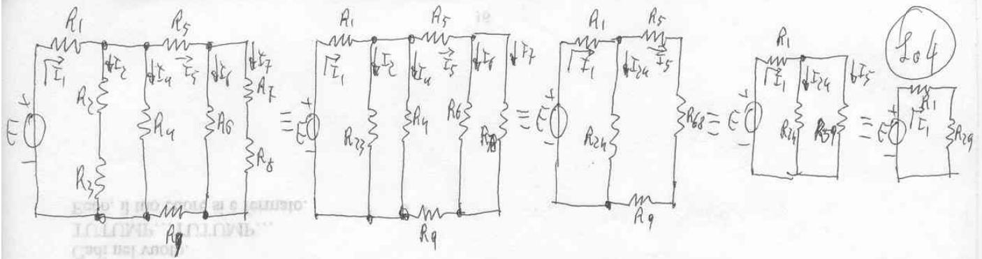
$$1.- R_{23} = R_2 + R_3 = 4,7 \cdot 10^3 + 3,9 \cdot 10^3 = 8,6 \text{ k}\Omega; R_{78} = R_7 + R_8 = 6,8 \cdot 10^3 + 1 \cdot 10^3 = 7,8 \text{ k}\Omega$$
