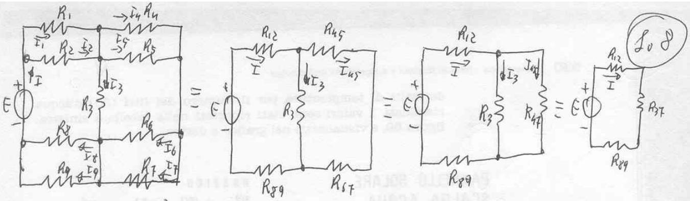
$$1. - R_{12} = \frac{R_1 R_2}{R_1 + R_2} = \frac{1 \cdot 10^3 \cdot 4,17 \cdot 10^3}{1 \cdot 10^3 + 4,17 \cdot 10^3} = 0,82 K\Omega; \quad R_{45} = \frac{R_4 R_5}{R_4 + R_5} = \frac{3,9 \cdot 10^3 \cdot 1 \cdot 10^3}{3,9 \cdot 10^3 + 1 \cdot 10^3} = 0,77 K\Omega;$$
