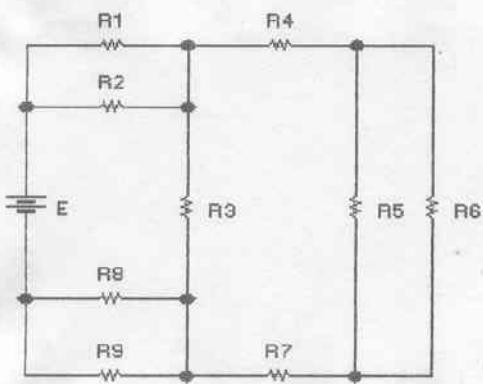
$$E = 100 \text{ V} ; R_1 = 1 \text{ K}\Omega ; R_2 = 4,7 \text{ K}\Omega ; R_3 = 3,9 \text{ K}\Omega ; R_4 = 3,3 \text{ K}\Omega ; R_5 = 1 \text{ K}\Omega ; R_6 = 1,5 \text{ K}\Omega ; R_7 = 6,0 \text{ K}\Omega ; R_8 = 4 \text{ K}\Omega ; R_9 = 4,7 \text{ K}\Omega .$$
