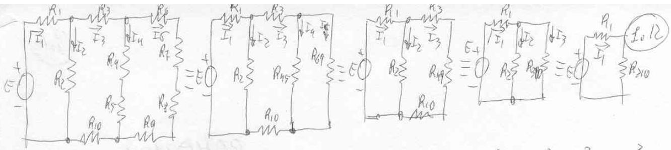
$$I_0 = R_{45} = R_4 + R_5 = 3,3 \cdot 10^3 + 1 \cdot 10^3 = 4,3 \text{ k}\Omega; \quad R_{69} = R_6 + R_7 + R_8 + R_9 = 1,5 \cdot 10^3 + 1,8 \cdot 10^3 + 1 \cdot 10^3 + 1,7 \cdot 10^3 = 4,7 \text{ k}\Omega$$
