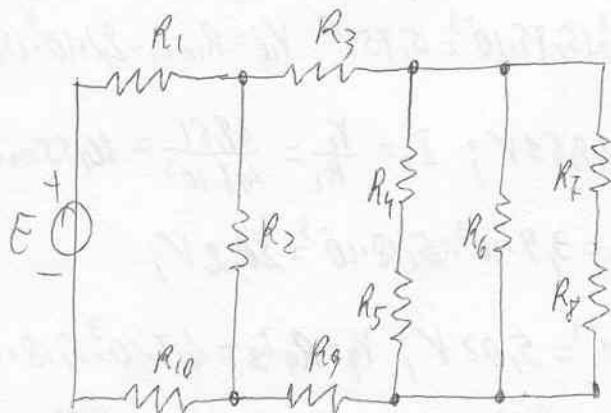
$$E = 100 \text{ V} ; \quad R_1 = 1 \text{ K}\Omega ; \quad R_2 = 4,7 \text{ K}\Omega ; \quad R_3 = 3,9 \text{ K}\Omega ; \quad R_4 = 3,3 \text{ K}\Omega ; \quad R_5 = 1 \text{ K}\Omega ;$$
