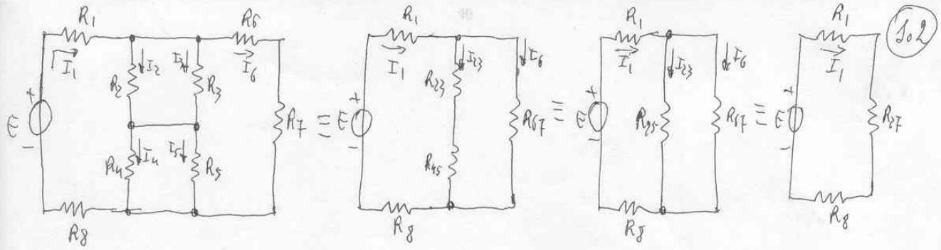
$$1.- \quad R_{23} = \frac{R_2 R_3}{R_2 + R_3} = \frac{4,7 \cdot 10^3 \cdot 3,9 \cdot 10^3}{4,7 \cdot 10^3 + 3,9 \cdot 10^3} = 2,13 \text{ k}\Omega; \quad R_{45} = \frac{R_4 R_5}{R_4 + R_5} = \frac{3,3 \cdot 10^3 \cdot 1 \cdot 10^3}{3,3 \cdot 10^3 + 1 \cdot 10^3} = 0,77 \text{ k}\Omega$$
