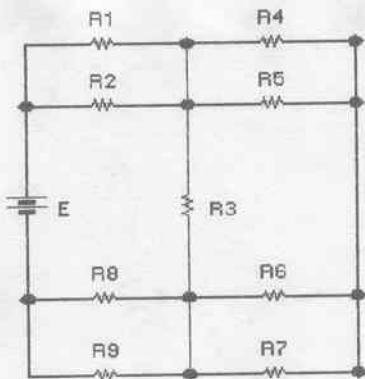
$$E = 100 \text{ V} ; \quad R_1 = 1 \text{ K}\Omega ; \quad R_2 = 4,7 \text{ K}\Omega ; \quad R_3 = 3,9 \text{ K}\Omega ; \quad R_4 = 3,3 \text{ K}\Omega ; \quad R_5 = 1 \text{ K}\Omega ; \\ R_6 = 1,5 \text{ K}\Omega ; \quad R_7 = 6,8 \text{ K}\Omega ; \quad R_8 = 1 \text{ K}\Omega ; \quad R_9 = 4,7 \text{ K}\Omega .$$
