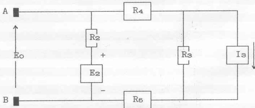
Si trasforma il generatore di corrente in generatore di tensione:
