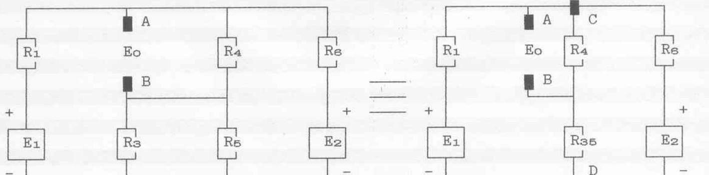
6.38 - Dato il circuito di figura, applicare il teorema di Thèvenin (Norton) tra i punti A e B. Del circuito equivalente ottenuto calcolare la tensione e la corrente tra i punti A e B.
