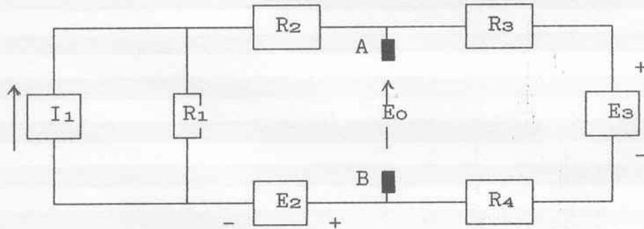
Si trasforma il generatore di corrente in generatore di tensione:
