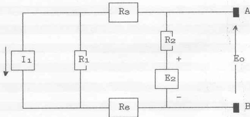
Si trasforma il generatore di corrente in generatore di tensione:
