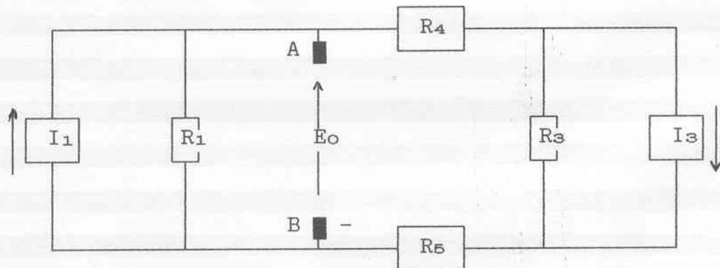
Si trasforma il generatore di corrente  $I_3$  in generatore di tensione:
